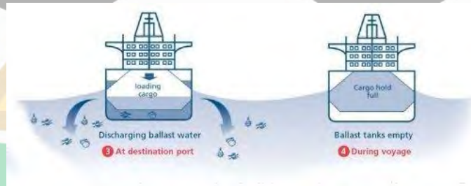
Gambar 2.1 Cara kerja sistem ballast
