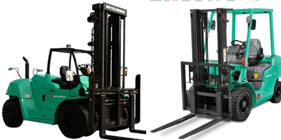
Gambar 2.7 Model forklift 7 ton (kiri) dan forklift 3 ton (kanan)
