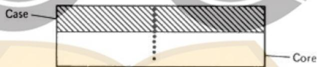
Gambar 2.7 Spesimen *croASTM-sectioned* untuk kasus menengah dan berat (*case depth* > 0,38 mm) (ASM Handbook, 1991).
