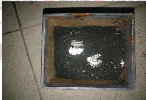
Gambar 3.3 Campuran Karbon Aktif dan BaCO<sub>3</sub> Pada Media *Pack Carburizing*
