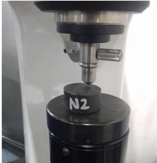
Gambar 3.7 Pengujian Kekerasan Metode Rockwell B
