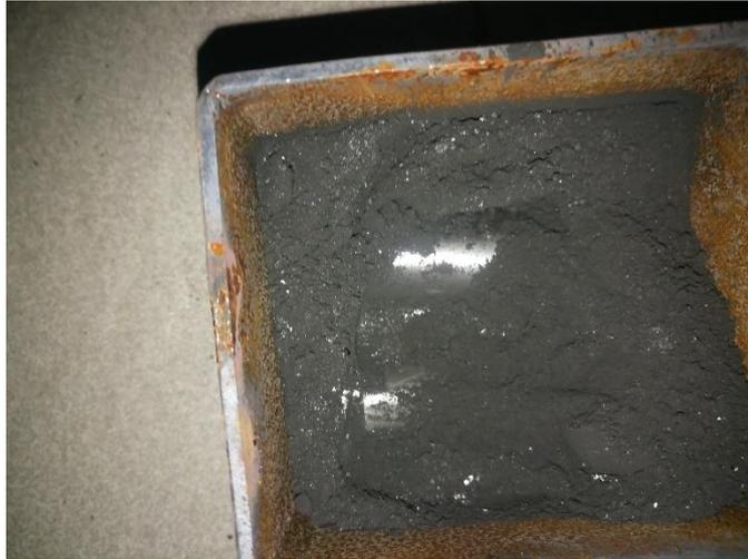
Gambar 3.4 Spesimen Ditimbun Karbon Aktif dan BaCO<sub>3</sub>
