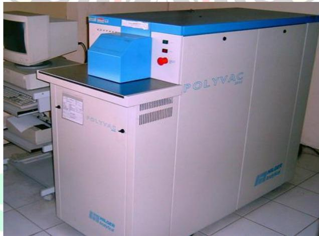
Gambar 3.11 Spektrometer Emisi
