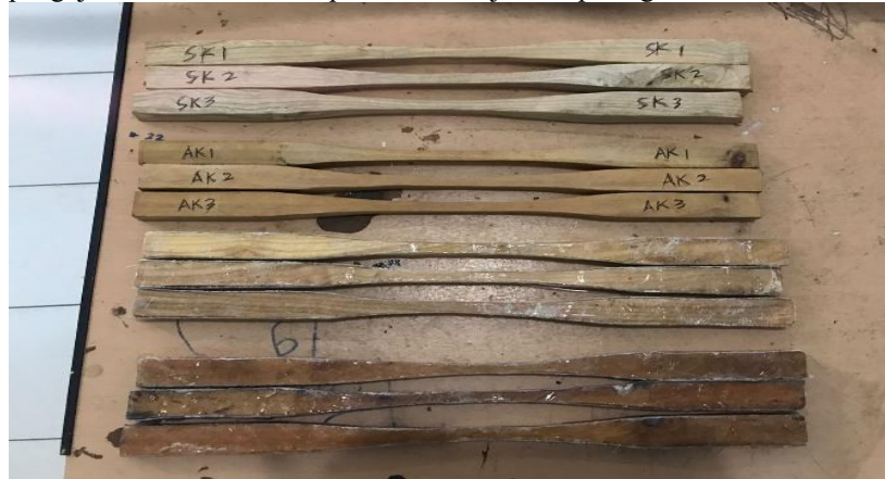
Gambar 2.6 Bentuk spesimen uji tarik SNI 03-3399-1994
