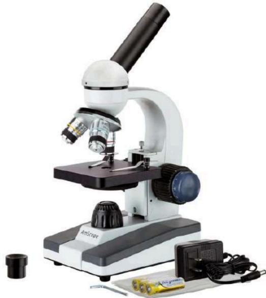
Uji Metalografi merupakan suatu metode yang digunakan untuk mempelajari struktur mikro dan fasa serta menganalisis ukuran butir pada material logam melalui pengamatan di bawah mikroskop optik. Pengujian ini Menggunakan standar ASTM E3-01 dan ASM Volume 09.
