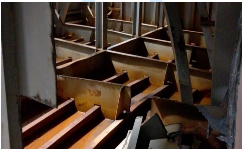
Gambar 3.2 Tampak Konstruksi Dalam Barge 300 ft.
