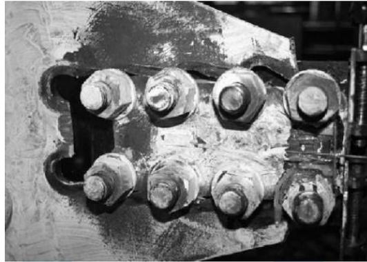
**Gambar 2. 16** Keruntuhan geser blok pada struktur baja
