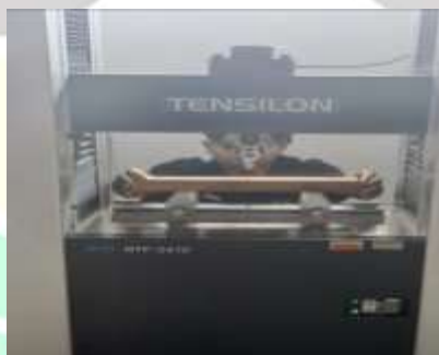
Gambar 4. 16 Pemasangan Spesimen pada Mesin Uji Bending (Sumber: Dokumentasi Pribadi, 2025)
