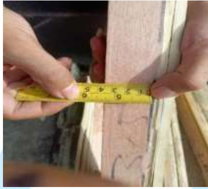
Gambar 4. 12 Spesimen 70 % kayu meranti x 30 % bambu (Sumber: Dokumentasi Pribadi, 2025)
