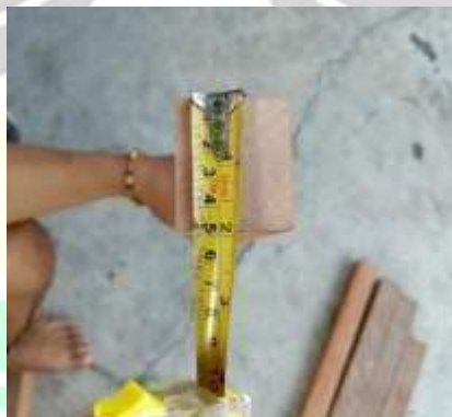
Gambar 4. 11 Spesimen 100% kayu meranti (Sumber: Dokumentasi Pribadi, 2025)
