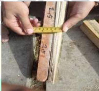
Gambar 4. 14 Spesimen 50 % kayu meranti x 50 % bambu (Sumber: Dokumentasi Pribadi, 2025)
