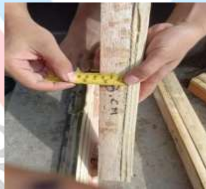
Gambar 4. 13 Spesimen 60 % kayu meranti x 40 % bambu (Sumber: Dokumentasi Pribadi, 2025)
