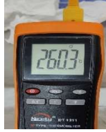
Gambar 3. 16 thermocouple untuk menjaga kestabilan temperatur
