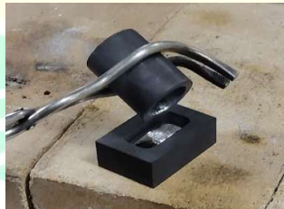
Gambar 3. 4 Penuangan paduan kedalam cetakan grafit
