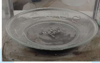
Gambar 3. 10 proses penimbangan sampel pengujian DSC
