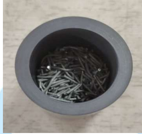
Gambar 3. 2 Pemasukan material ke dalam krusibel
