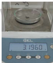
Gambar 3. 14 penimbangan sampel untuk mencari nilai W
