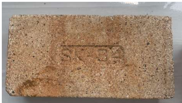
Refraktori SK-34 yang digunakan untuk dinding Furnace
