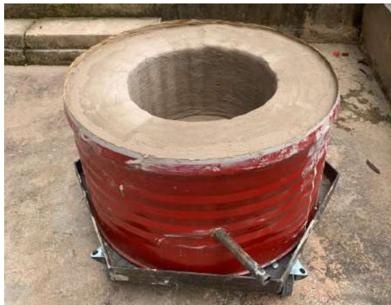
Furnace silinder yang digunakan sebagai objek penelitian
