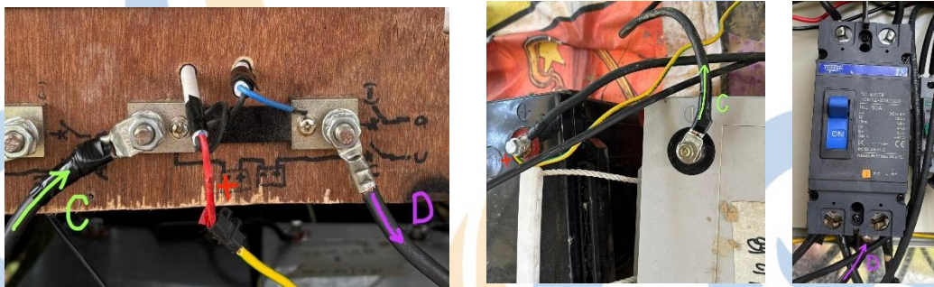
Gambar 4. 4 Titik Pembacaan Sensor pada Sisi Baterai
