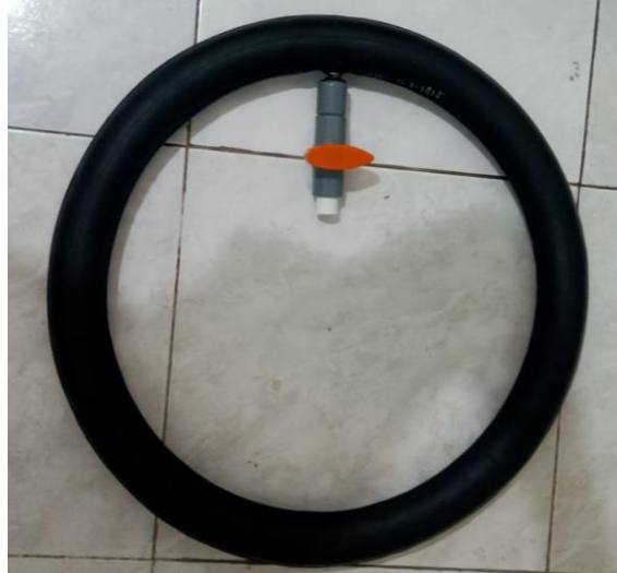
Gambar 4 : Ban dalam sebagai penyimpan biogas
