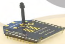
Gambar 2.4 Modul Xbee komponen yang dikembangkan untuk menggunakan protokol Zigbee (Piyare, 2016)
