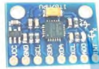
Gambar 2.3 Modul sensor MPU 6050 (Irawan, 2015).
